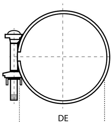
**Funzione:** Riparazione rapida di rotture su tubi. **Nota:** la dimensione della rottura non deve superare il 30% della lunghezza della fascia.
