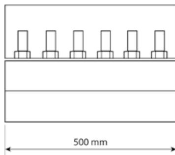
**Funzione:** riparazione e giunzione. **Nota:** la dimensione della rottura non deve superare il 30% della lunghezza della fascia. Per la giunzione la distanza tra i 2 tubi non deve superare i 5 mm e 3 mm di disassamento
