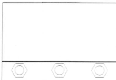
**Funzione:** riparazione e giunzione. **Nota:** la dimensione della rottura non deve superare il 30% della lunghezza della fascia. Per la giunzione la distanza tra i 2 tubi non deve superare i 5 mm e 3 mm di disassamento
