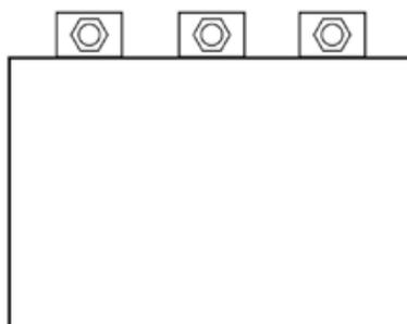
**Funzione:** riparazione rapida di rotture su tubi. **Nota:** la dimensione della rottura non deve superare il 30% della lunghezza della fascia.
