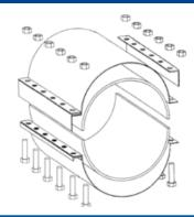
**Funzione:** riparazione e giunzione. **Nota:** la dimensione della rottura non deve superare il 30% della lunghezza della fascia. Per la giunzione la distanza tra i 2 tubi non deve superare i 5 mm e 3 mm di disasamento
